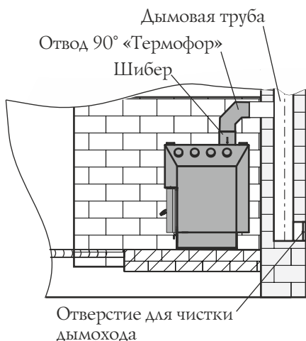
Рисунок 13. Схема присоединения котла к стационарному дымоходу
